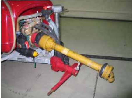
Fig. 4 – Lato anteriore con timone, filtro di aspirazione, pompa e indicatore di livello
