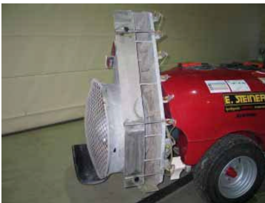
Fig. 6 – Ventilatore assiale con girante da 800 mm
