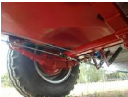
Sospensioni a balestra e alloggiamento per l'assale motore
