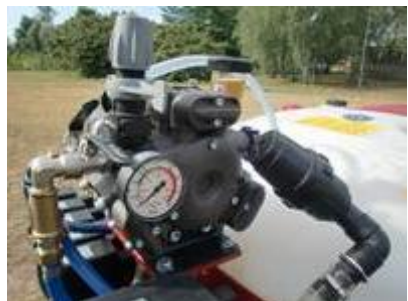
Pompa ausiliaria per il lavaggio
