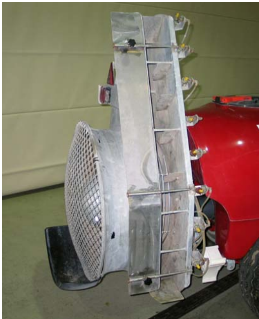
Abb. 5 und 6: Axialgebläse 33" mit einseitiger Gebläseabdeckung (linkes Bild); Flüssigkeitsverteilung (oben) am Vertikalverteilungsprüfstand (Düsen: ATR grün).
