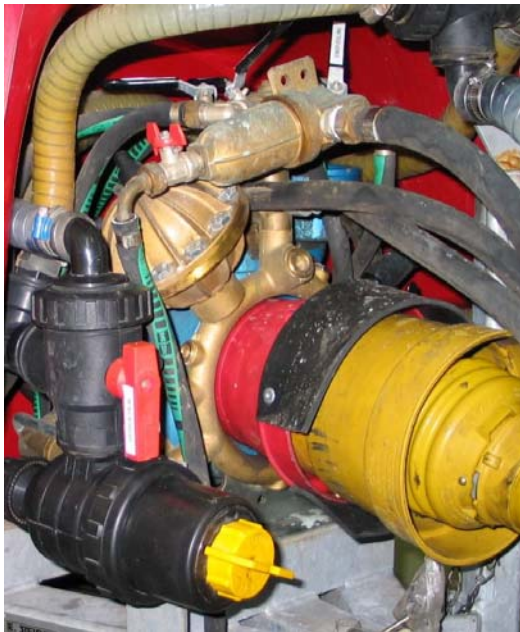
Abb. 4: Dreikammer-Membranpumpe CP 125 K, vorn rechts Saugfilter mit Dreiwegeventil zur Umschaltung zwischen Spülwasser- und Gerätebehälter.
