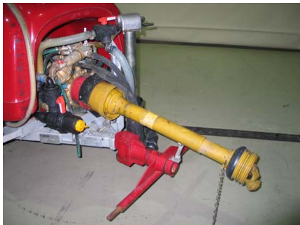
Abb. 2: Knickdeichsel, Unterlenkeranhangung mit Ablage für die Gelenkwelle.
