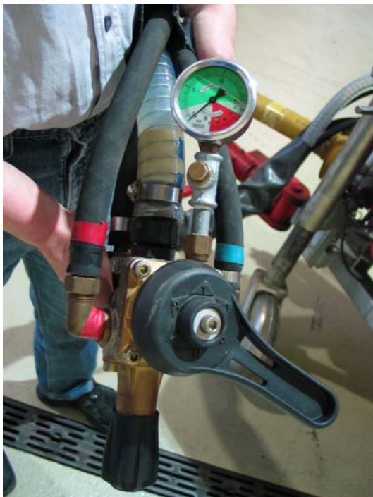
Abb. 11: Handarmatur mit Manometer und entsprechend langen Schläuchen.
