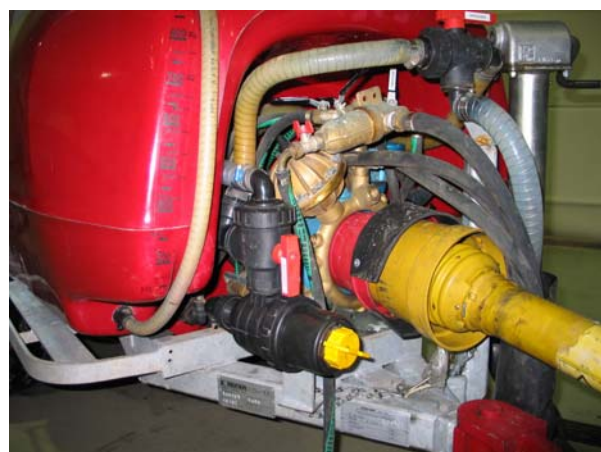
Abb. 3: Füllstandsanzeige mittels Füllstandsschlauch vorn rechts.
