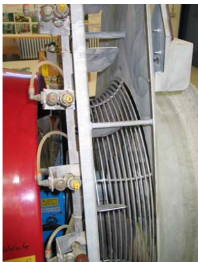
Abb. 10: Die Flachstrahldüsen werden mit Bajonettkappen in Position gehalten..
